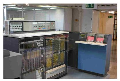
L'IBM 360, lanciato sul mercato nel 1964, rappresenta il primo e-sempio di computer di terza generazione perché era costruito utilizzando, i primi *Circuiti Integrati*, basati sul silicio, in sostituzione dei Transistor fino ad allora impiegati. Con la serie 360 l'IBM introduceva il concetto di modularità, infatti, contrariamente a quanto era avvenuto fino ad allora nell'industria, veniva creata una vera e propria famiglia di macchine tutte utilizzanti il medesimo lin-
