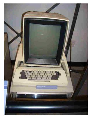
Lo XEROX ALTO nasce nei laboratori della Xerox di Palo Alto nel 1972. Può essere considerato come il primo computer nella storia ad essere dotato di un sistema di visualizzazione orientato alla grafica. Lo Xerox Alto rimarrà un concept computer, ma darà il via al progetto XEROX STAR del 1981, il primo computer in assoluto disponibile sul mercato dotato di interfaccia GUI (*Graphical User Interface*), comunemente abbreviata in *Interfaccia Grafica*.
