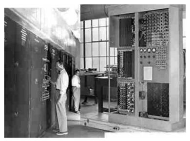
L'EDVAC, acronimo di *Electronic Discrete Variable Automatic Computer*, fu progettato dagli stessi progettisti dell'ENIAC basandosi sull'architettura dello scienziato, di origine Ungherese, Jhon Von Neumann. Fu messo a punto nel 1951. Può essere considerato come il successore dell'ENIAC, anche se le differenze tra i due computer sono profonde: l'ENIAC nasceva come computer a programma cablato, ossia il programma era parte della macchina stessa, mentre l'EDVAC era un computer a programma memo-
