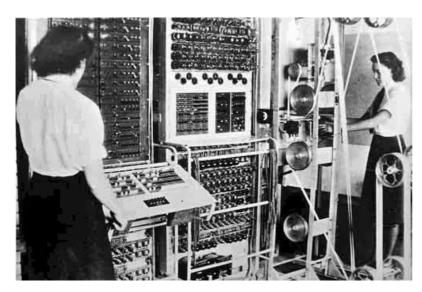
COLOSSUS è stato il primo computer elettronico programmabile nella storia dell'informatica. Fu costruito e messo in opera in Inghilterra, durante la seconda guerra mondiale, per decifrare i messaggi tedeschi codificati con la Macchina Enigma. Era interamente realizzato mediante l'impiego di valvole termoioniche, fino ad allora usate solo per gli amplificatori. Il suo primato cronologico, tuttavia, è stato riconosciuto in ritardo a causa del rigoroso segreto im-
